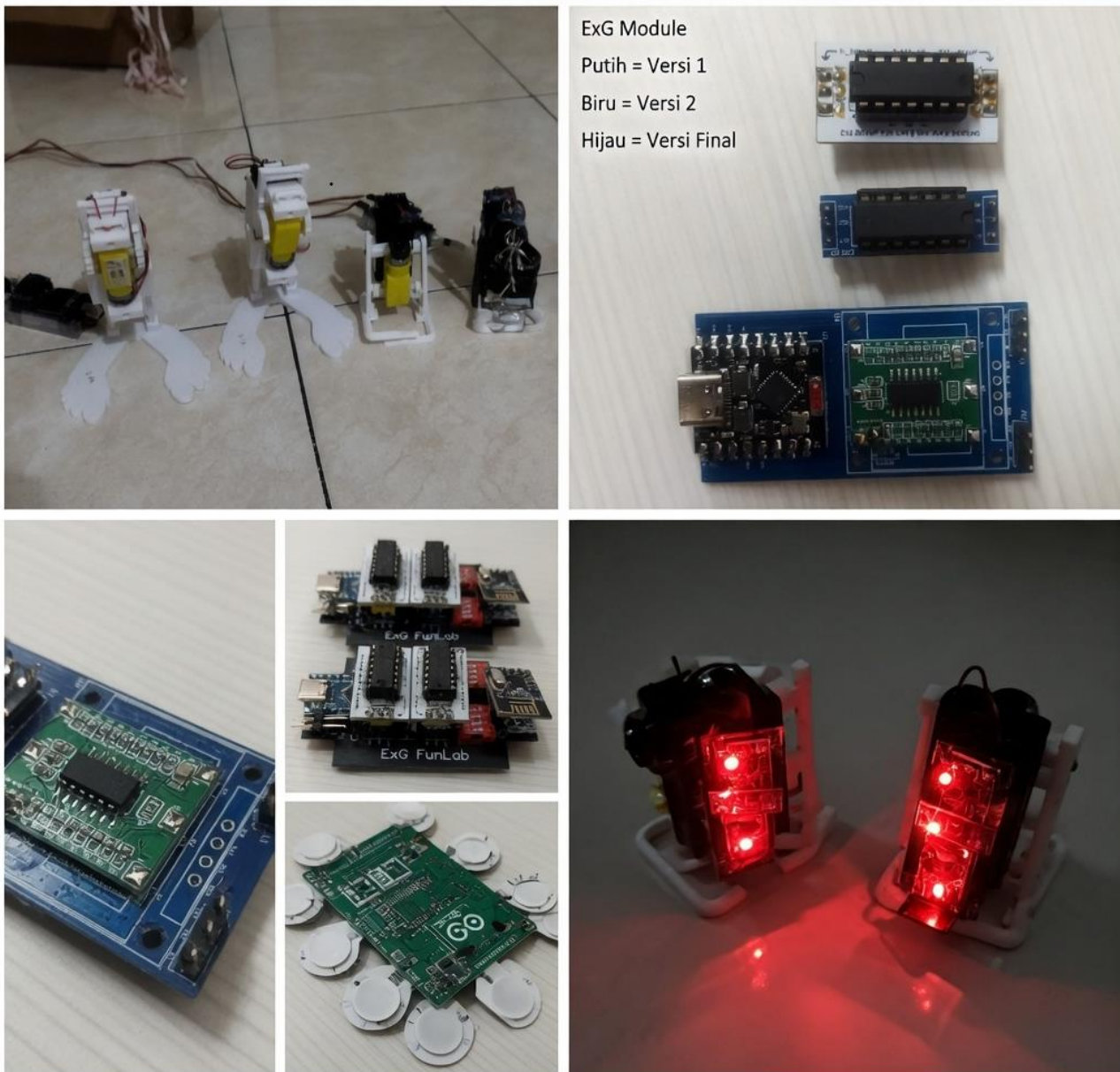
Gambar 6. Platform Robot, Modul ExG dan Perangkat Sensor EMG/EOG yang Digunakan
